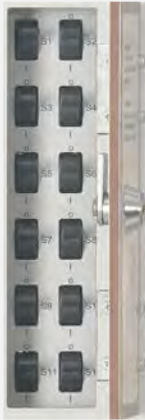
Fehlersimulator mit 12 Fehlermöglichkeiten über Schalter
