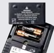
Vano separato per batterie e fusibili
