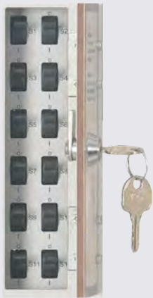
Simulatore con 12 possibilità di guasto tramite interruttori
