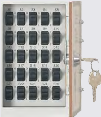
Simulatore con 25 possibilità di guasto tramite interruttori
