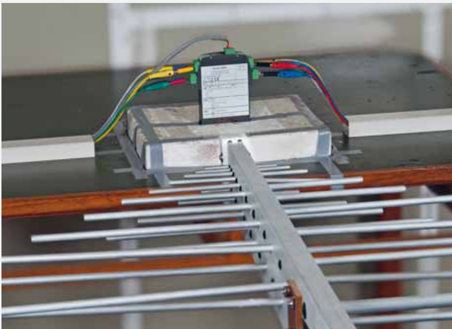
Prüfung eines SINEAX V604s auf Störfestigkeit gegen hochfrequente elektromagnetische Felder
