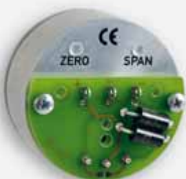
Anschlussprint mit Trans-Zorb-Diode
