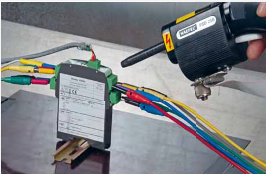
Prüfung eines SINEAX V604s auf Störfestigkeit gegen elektrostatische Entladungen (ESD)
