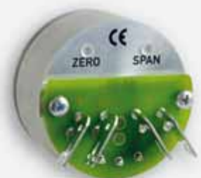
Anschlussprint mit AMP Verbindungen
